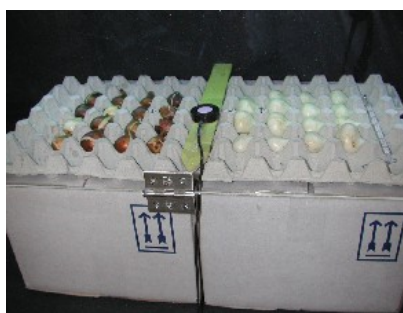
Fig. 2.2: Opstelling voor het bestralen van tulpenbollen.
