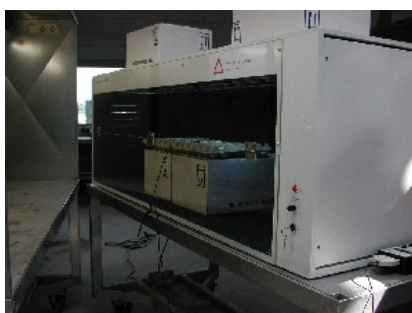
Fig. 2.2: Opstelling voor het bestralen van tulpenbollen.
